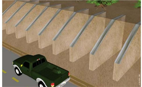
Raidissement de talus en déblai par mise en œuvre d'épis transversaux.
