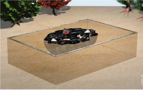
Réalisation d'écrans d'étanchéité pour confinement de zones polluées ; réduction des débits de percolation.
