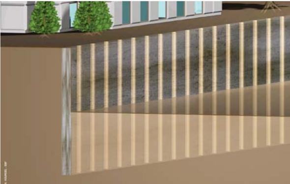
Réalisation de soutènements provisoires en association avec la mise en place d'éléments verticaux résistants (profilés métalliques, tubes, poteaux).
