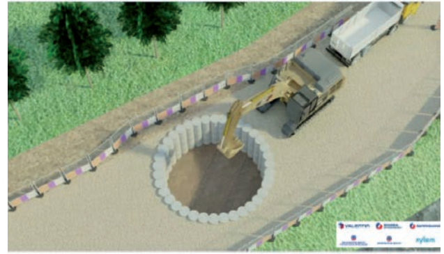
Terrassement du pieux et démolition de l'ouvrage existant
